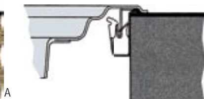
Detail uchycení Top Clip do dřeva (obr. A) a žuly (obr. B)
